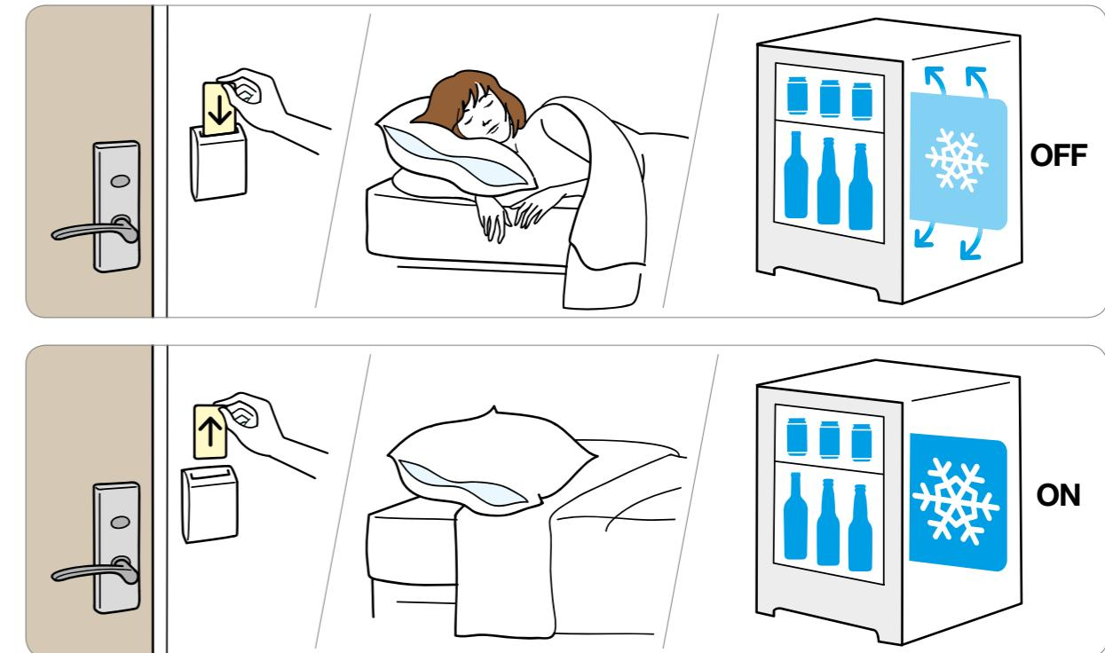
**Il Sistema Smart regola l'accensione e lo spegnimento del compressore in base alla presenza o assenza dell'ospite in camera.** L'utilizzo del Sistema Smart richiede la presenza in camera di un Energy Saver: una tasca porta card per il risparmio energetico.
